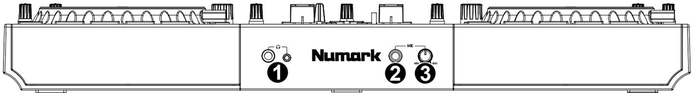
1. **ヘッドホン端子:** 6.35 mm または 3.5 mm プラグのヘッドフォンをこの出力に接続し、キューイングやミックスモニターとして使用します。ヘッドフォンのボリュームは、Cue Gain ノブで調整します。
